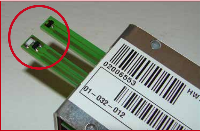
Reinigen Sie den Luftmengensensor mit einem weichen Pinsel. Die Bauteile auf dem Sensor müssen frei from Verschmutzungen sein. Setzen Sie die Dichtplatte auf den Luftmengensensor. Danach bauen Sie den Luftmengensensor wieder ein.
