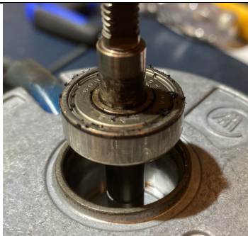
Lager herausziehen (in dem man die zwei Motorteile auseinanderzieht)
