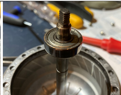
Lager herausziehen (in dem man die zwei Motorteile auseinanderzieht)
