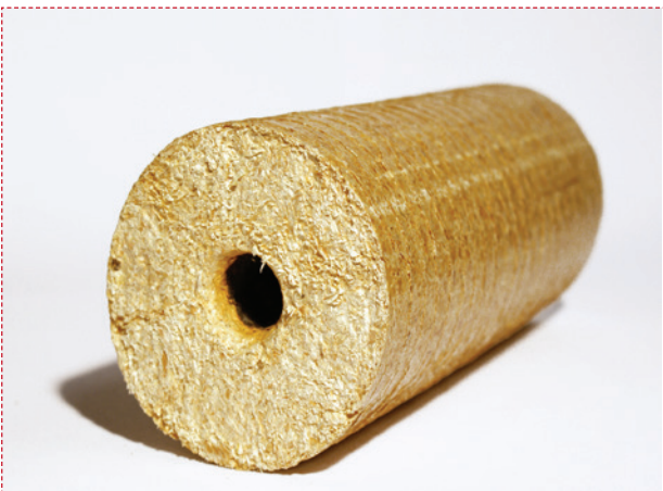
Holzbrikett nach ÖNorm M 7135 und DIN 51731 in runder Form
