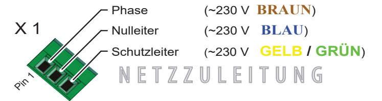
Steckerbelegung (X1, X4, X5, X9, X10, X3, X11) Phönix RM 5,08 3-poliger Steckverbinder mit Schraubanschluss oder Federzugklemmen
